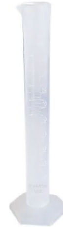
Probeta de 100 mL base hexagonal en polipropileno traslúcido Graduación con precisión de 1 mL
